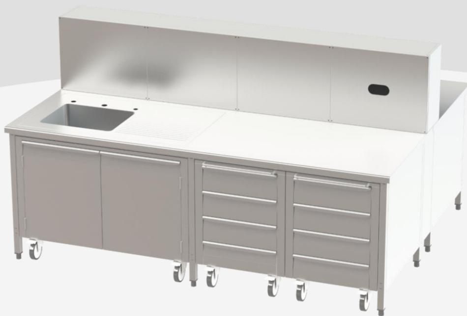
Piano di lavoro spessore 12/10 rinforzato e completo di tamponamento inox sottopiano. Bordo frontale raggiato R10, laterali R2. Sponda centrale H=500mm, raggiata R10 sul piano di lavoro, scatolata per alloggiamento prese elettriche di Vs. fornitura.
