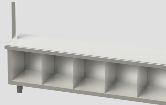
Estructura en tubo de acero inoxidable AISI 304 mm40x40, espesor 10/10mm, totalmente soldado, acabado Scotch Brite. Paneles laterales soldados que cierran los lados, divisores verticales que identifican 6 compartimentos accesibles desde un solo lado. Encimera de acero inoxidable en AISI 304 espesor 1,20mm con refuerzo interno y taponamiento de acero inoxidable inferior. Lados largos redondeado R10. Patas de nivelación. Estructura superior para colgar completa con ganchos en forma de L.
